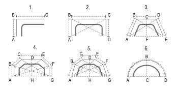
Угловой изгиб (эркер)  $90^{\circ}$ — $180^{\circ}$  R=120 мм (рис. 1, 2, 3, 4, 5)
